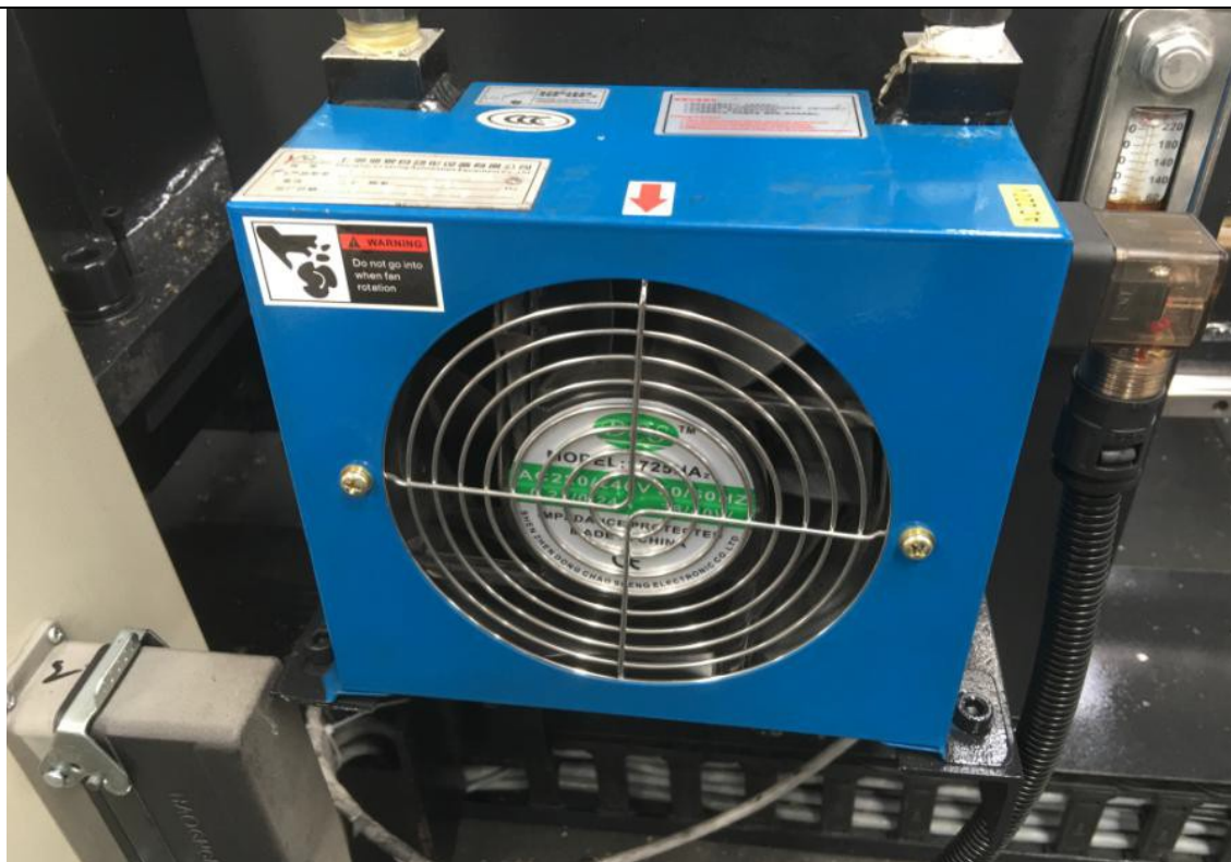
Гидравлическая система, оснащенная воздушным охлаждением, поддерживает температуру масла
