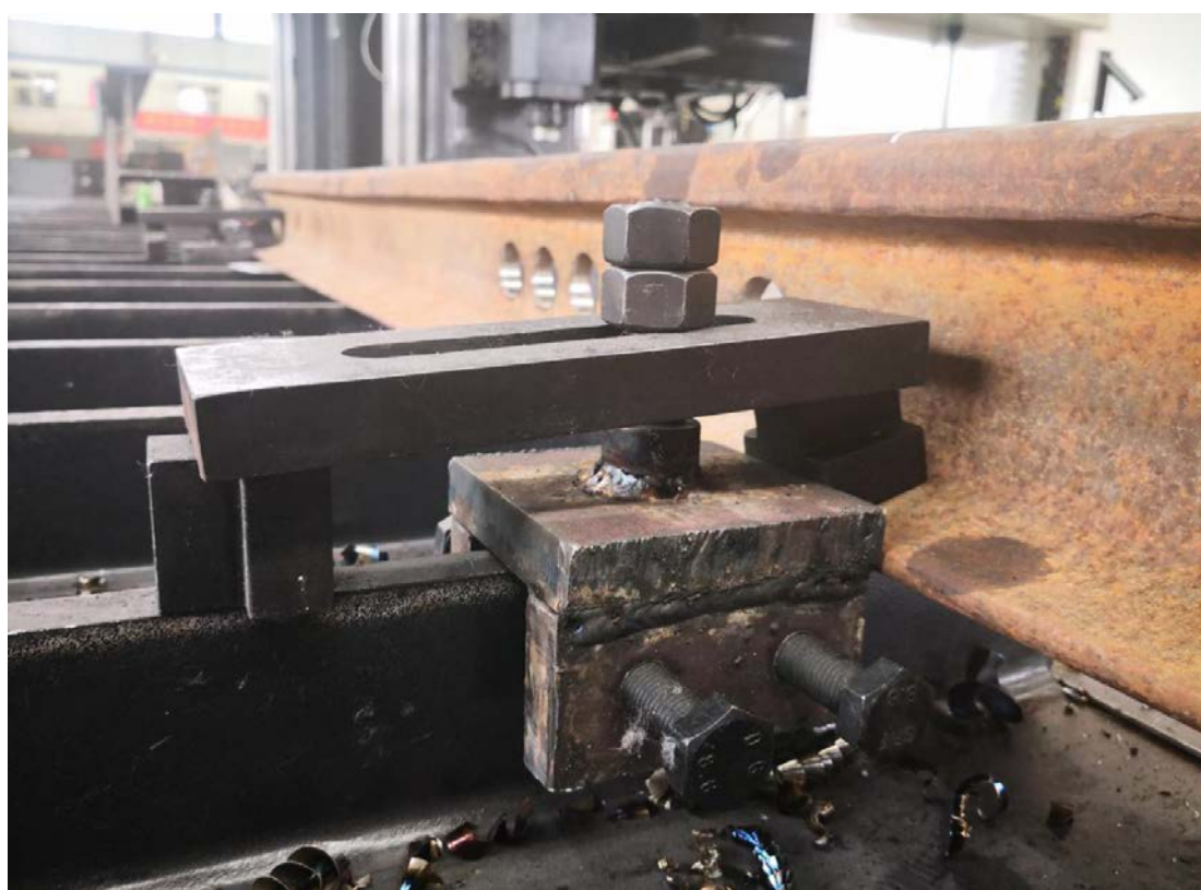
Зажимные приспособления. Операция зажима очень проста. Мы также можем разработать новые зажимы для различных форм заготовок.
