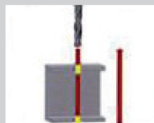
Сверление толковой подачей полых профилей
